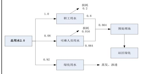
图2-1 项目水平衡图 (消耗单位: m³/d)
