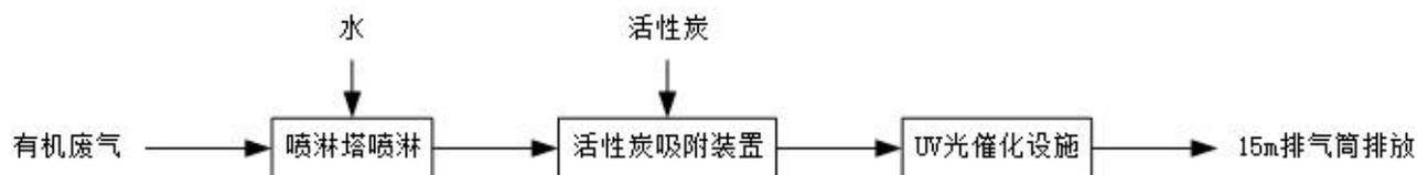
图 3-1 “喷淋+活性炭+UV光催化”废气处理设施工艺图
