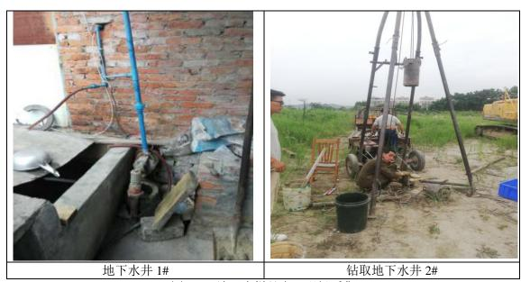
图 7-2 地下水样品人工现场采集
