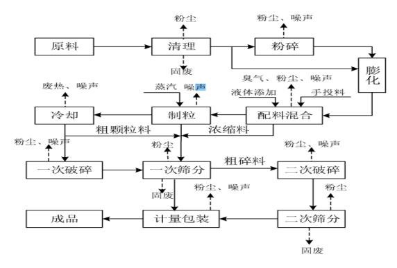
图 3-2 饲料生产工艺流程及产污环节图
