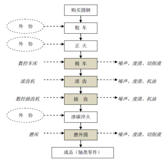
图 2-4 轴类零件(圆钢)加工工艺过程及产污环节图
