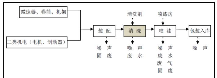
图 2-12 设备加工工艺过程及产污环节图
