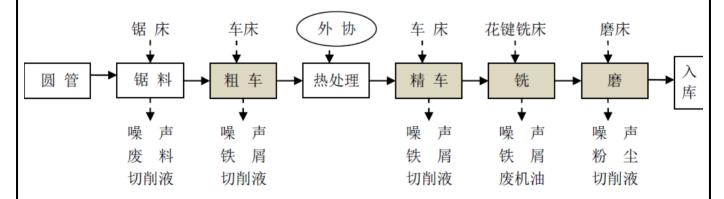
图 2-16 搅拌轴加工工艺过程及产污环节图
