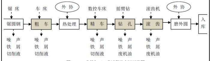
图 2-13 齿轮加工工艺过程及产污环节图
