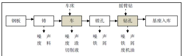
图 2-14 基座加工工艺过程及产污环节图
