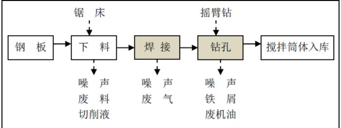
图 2-17 搅拌筒体加工工艺过程及产污环节图
