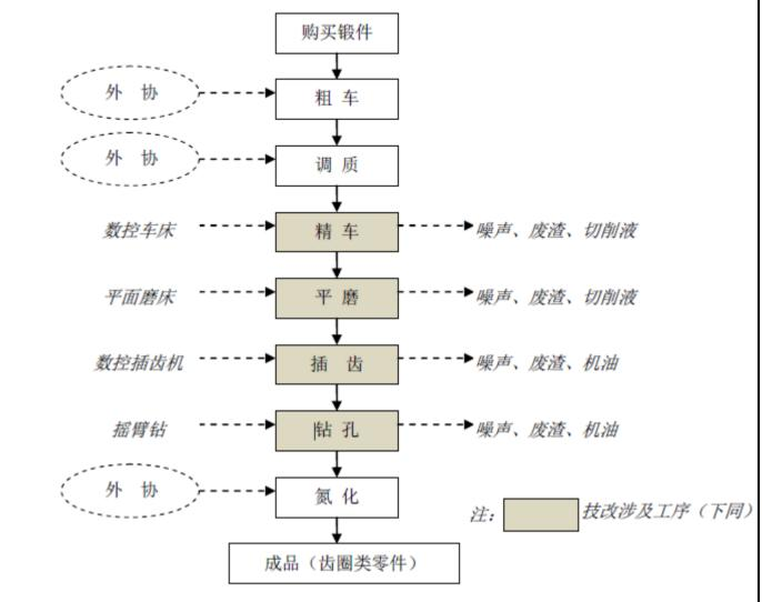
图 2-3 齿圈类零件(锻件)加工工艺过程及产污环节图
