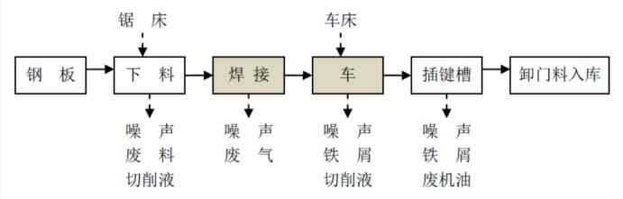
图 2-18 搅拌筒体加工工艺过程及产污环节图
