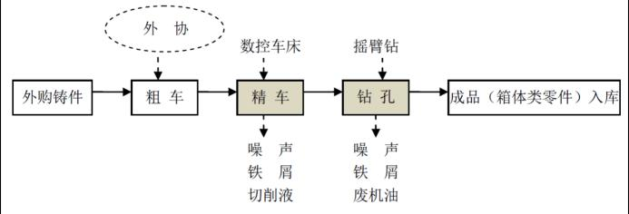
图 2-5 箱体类零件 (铸件) 加工工艺过程及产污环节图
