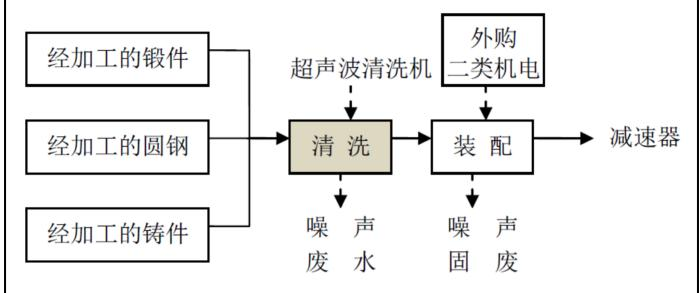
图 2-6 设备组装工艺过程及产污环节图
