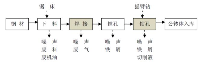
图 2-15 公转体加工工艺过程及产污环节图
