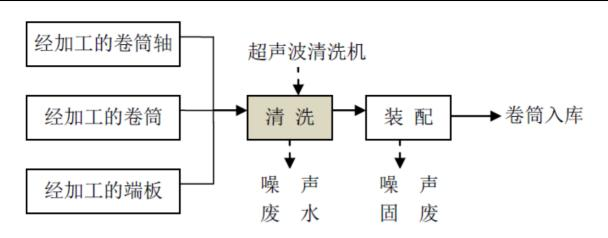
图 2-10 设备组装工艺过程及产污环节图
