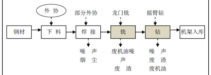
图 2-11 机架加工工艺过程及产污环节图
