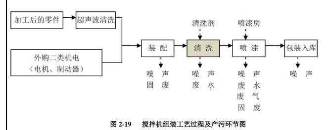
在组装过程中,有 2 次清洗过程。第一次清洗位于转配工序前,在车间内清洗 区进行,将超声波清洗剂及清水(超声波清洗剂的使用浓度为 3%-5%)倒入超声波 清洗机中,利用超声波清洗加工成型的齿圈类零件、轴类零件及箱体类零件。第二 次清洗位于装配完成后,喷漆工序前,此次清洗在喷漆房旁边的清洗房内进行,利 用高压水枪将金属清洗剂(不添加水)喷射在设备表面进行清洗。
