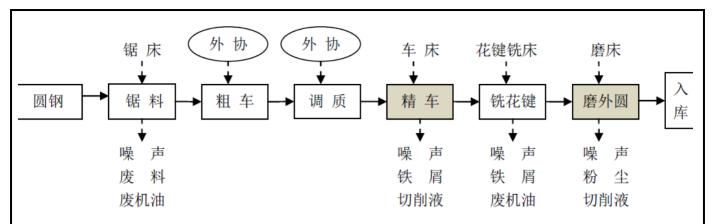
图 2-7 卷筒轴加工工艺过程及产污环节图
