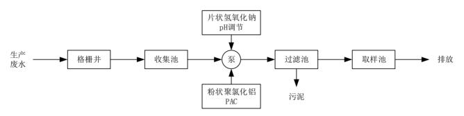
图 3-1 生产废水处理设施工艺图
