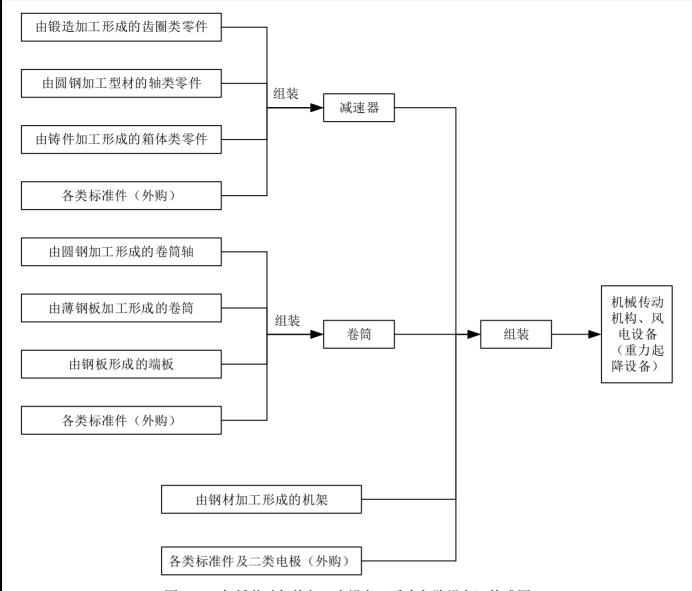
图 2-2 机械传动机构与风电设备(重力起降设备)构成图
