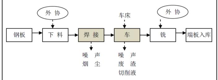
图 2-9 端板加工工艺过程及产污环节图
