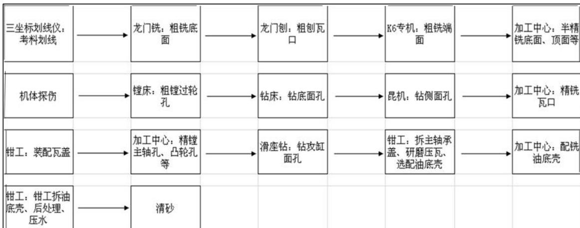
图4.2-3 机体加工生产工艺流程图
