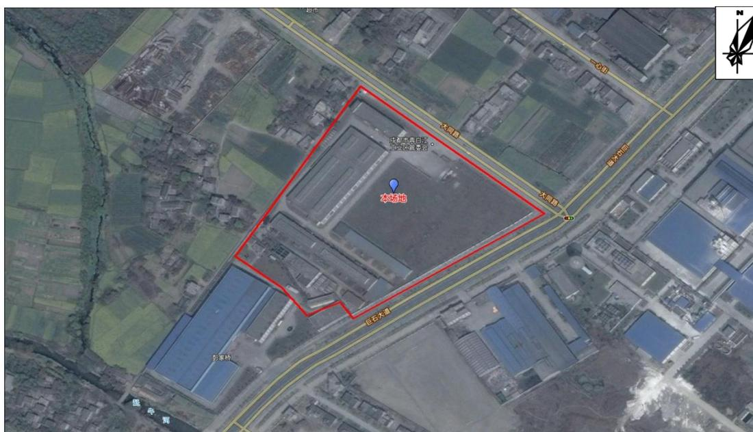
图 3.3-2 2007 年地块卫星图根据收集资料及人员访谈相关情况，此期间厂区主要用于电镀生产。喷塑车间位于厂区西侧，电镀车间位于厂区南侧，正大门东侧为办公楼，库房（内含化工库）位于电镀车间北面，污水处理站位于电镀车间南面，地块中央为空地。
