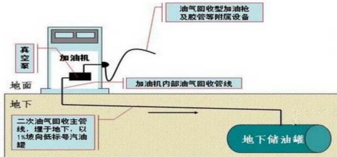
图 2-4 加油油气回收系统示意图
