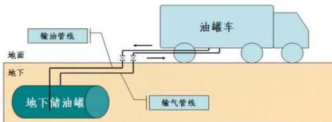
图 2-3 卸油油气回收系统示意图
