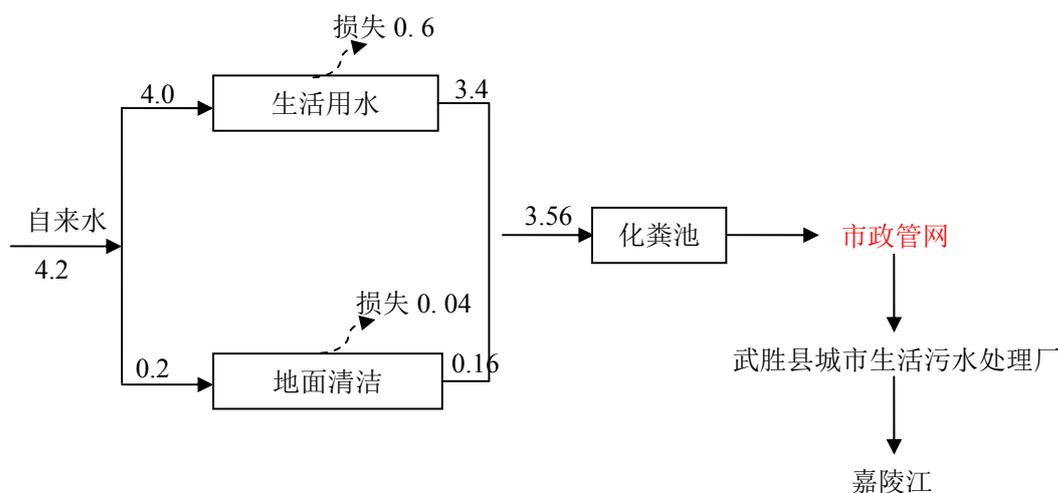
图 2-1 项目水平衡图 (单位:  $m^3/d$ )
