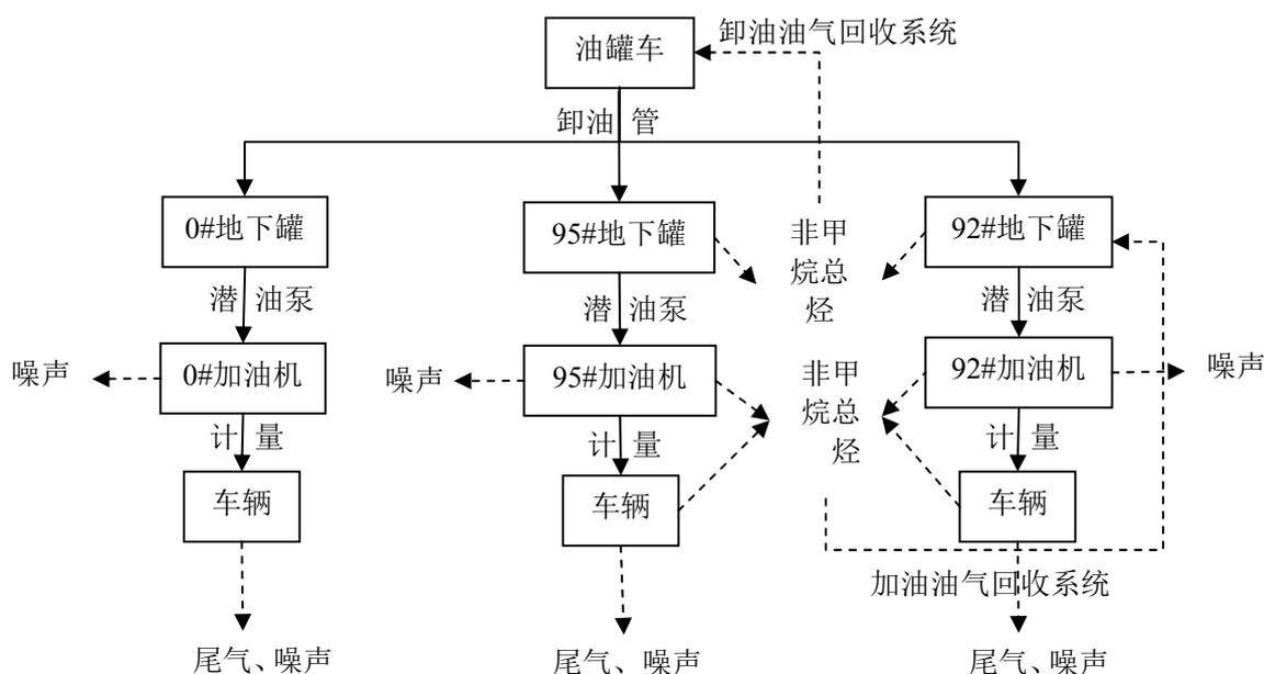
图 3-1 项目工艺流程及产污位置图
