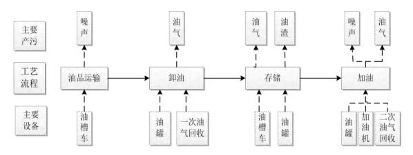
图 2-1 加油站工艺流程及产污位置图
