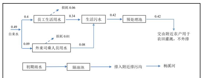
图 2-1 项目水平衡图 (消耗单位: m³/d)
