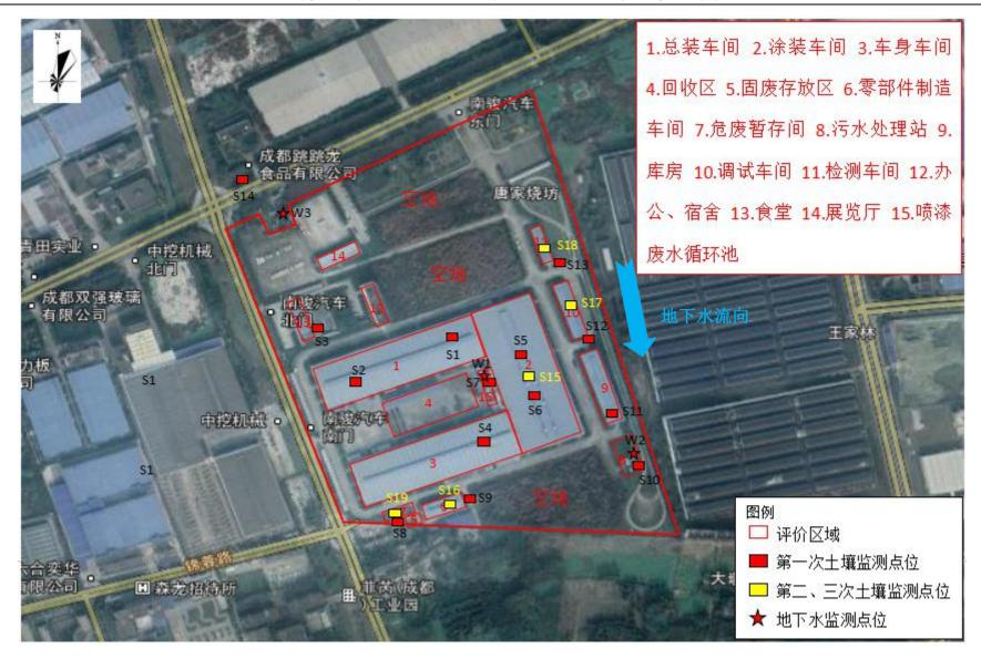
图 4.2-2 土壤和地下水采样监测布点图
