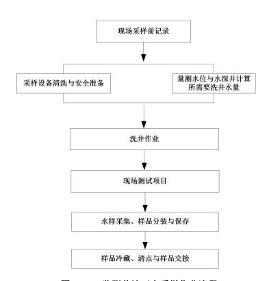
图 4.2-1 监测井地下水采样作业流程
